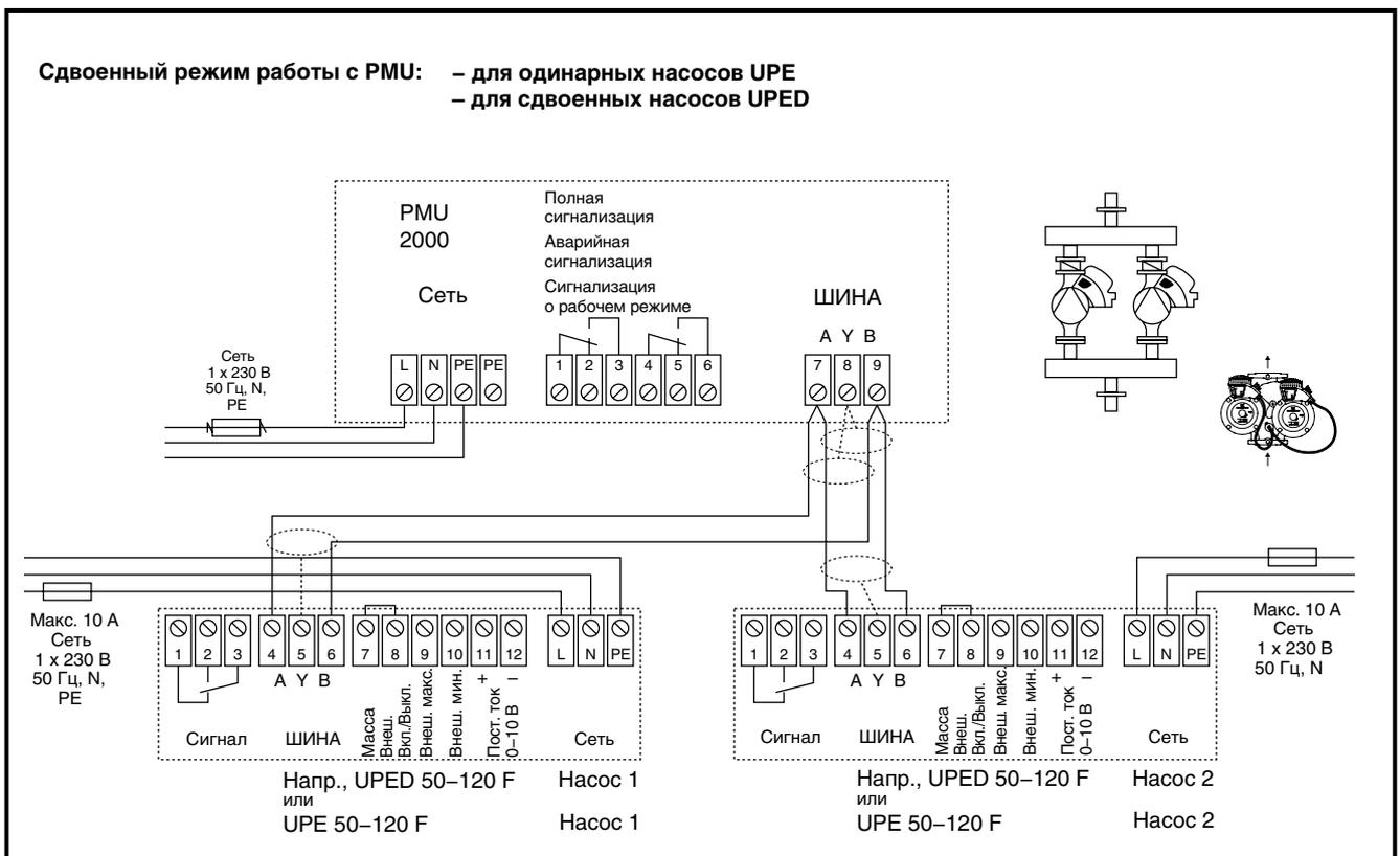
4. UPED 80–120 F в качестве сдвоенного насоса в одиночном режиме (одновременно или при необходимости)
