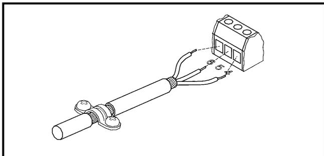
Для подключения к шине связи требуется применение двухжильного экранированного кабеля. Экранирующая оболочка должна с обоих концов подключаться к зажиму Y.
