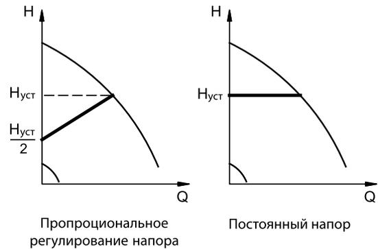
Рис. 2 Пропорциональное регулирование напора и постоянный напор
