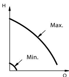
Рис. 4 Режим работы по максимальной и минимальной характеристике
