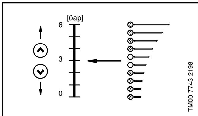
**Пример:** Насос находится в нерегулируемом режиме эксплуатации.
