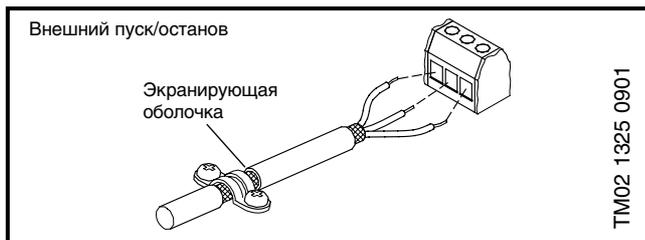
Для соединений с ШИНОЙ связи необходимо использовать 2-жильный экранированный кабель. Оба конца экранирующей оболочки должны подключаться к контактному зажиму Y.
