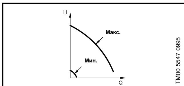
Режим работы, соответствующий максимальной характеристике («Макс.»), можно использовать при удалении воздуха из системы в процессе монтажа.
