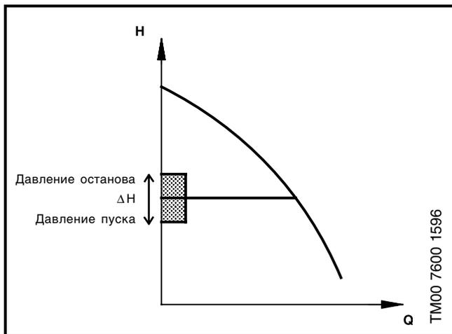
Функция останова требует наличия напорного гидробака, в котором должен быть создан подпор, составляющий 70% текущего заданного значения.
