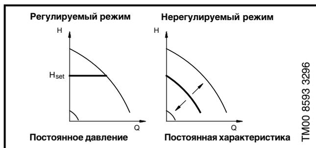
Кроме нормального режима эксплуатации, можно установить режимы «Останов – Stop» или «Макс.»
