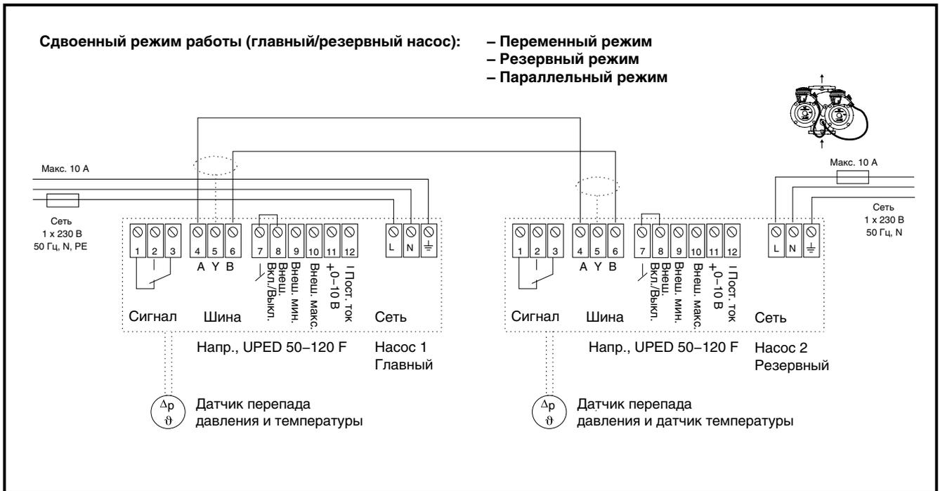
3. UPED 80–120 F используется в качестве сдвоенного насоса в переменном режиме, резервном режиме (главный и резервный насос) или параллельном режиме одновременно с
