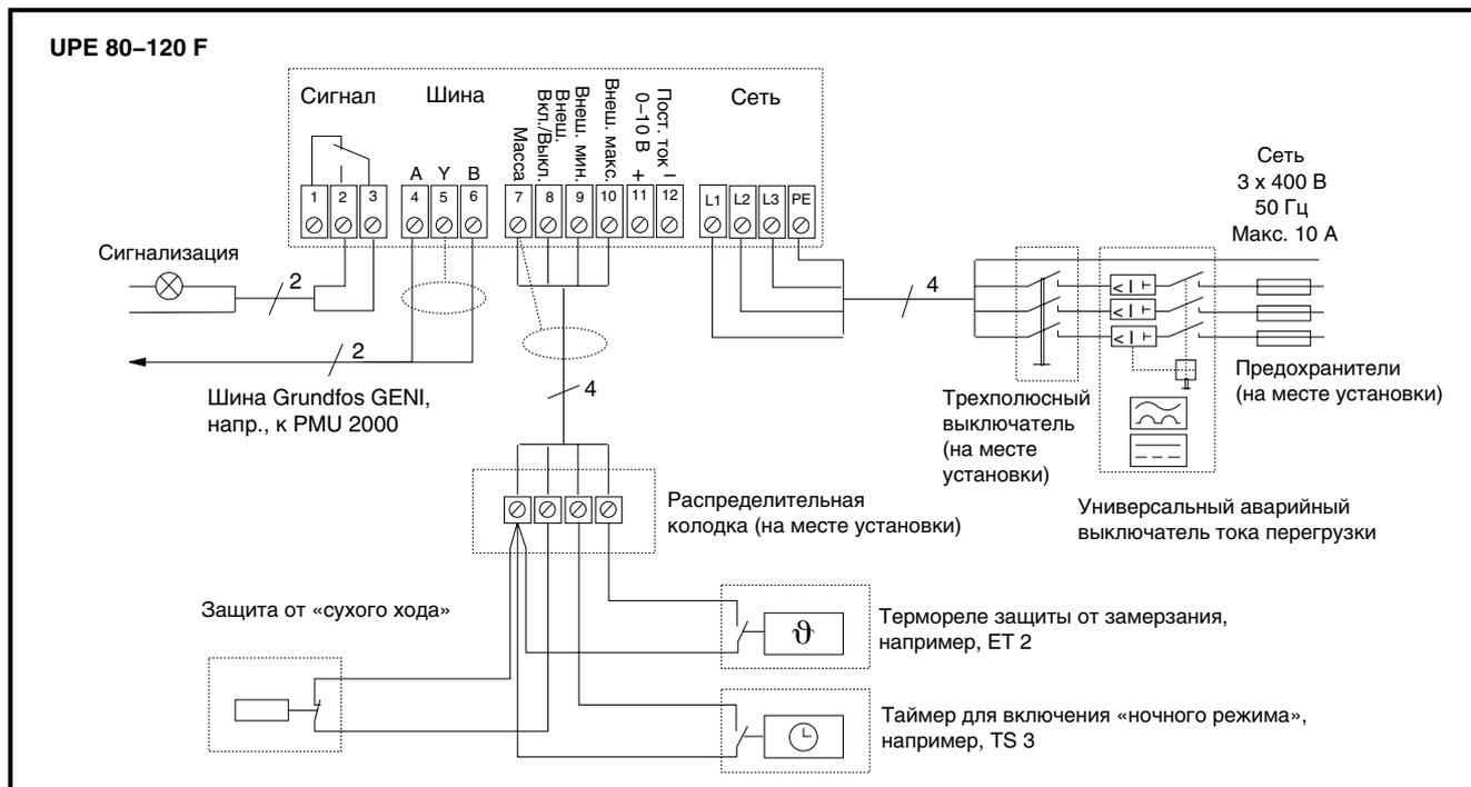
**1. UPE 80-120F в качестве насоса отопительного контура с внешним управлением:**
