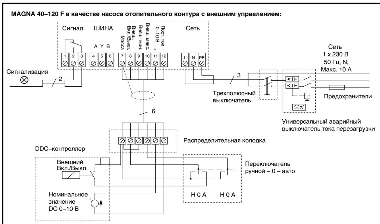
**2. MAGNA 40-120 F в качестве насоса отопительного контура с внешним управлением:**
