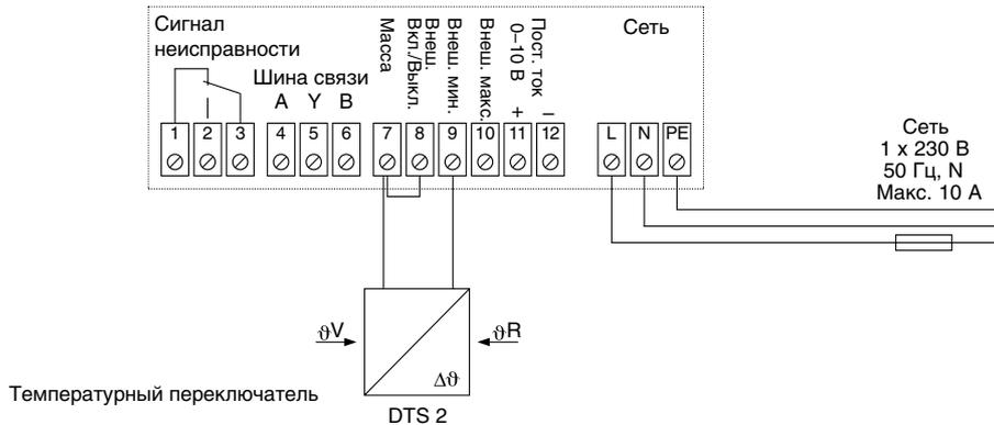
MAGNA 40–120 F с переключением в зависимости от перепада температур с помощью температурного переключателя DTS 2 между режимом регулирования и графической характеристикой МИН.
