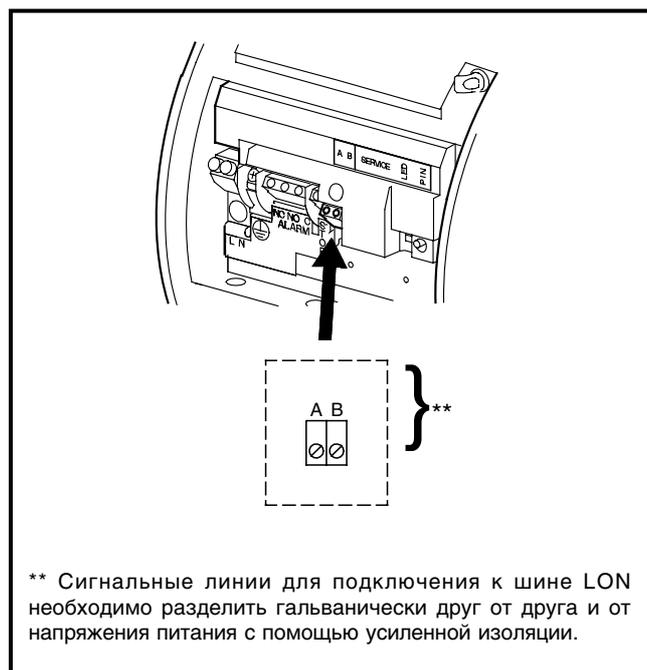
\*\* Сигнальные линии для подключения к шине LON необходимо разделить гальванически друг от друга и от напряжения питания с помощью усиленной изоляции.
